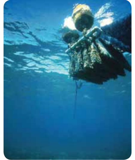
Figura 29. Ejemplos de colectores experimentales utilizados en los estudios de conectividad de la langosta espinosa para capturar a las postlarvas cuando regresan a sus hábitats de origen. La foto de arriba es un colector de tipo Witham utilizado para capturar a la langosta común del Caribe. La foto de abajo muestra un aparato experimental diseñado para atraer a las postlarvas de la langosta común del Caribe, a las cuales posteriormente se les proporciona un lugar para establecerse en las estructuras de las grietas, conforme dichas larvas van creciendo. Foto: Mark Butler (arriba); Desconocido (abajo)
